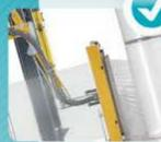
**Verschweißung des Folienendes.** Das Folienende wird durch die Impulsschweißeinrichtung hochregelsicher verschweißt. Durch eine zustellbare Gegenplatte wird ein Kontakt mit dem Produkt vermieden.
