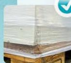
**Folienstauchvorrichtung.** Extrem einfach - extrem effektiv! Verbessert den Verbund zwischen Palette und Stapel erheblich. Die Einfahröffnungen an der Palette bleiben dabei frei. Die Folienwicklung wird so beim weiteren Handling der Palette nicht beschädigt.
